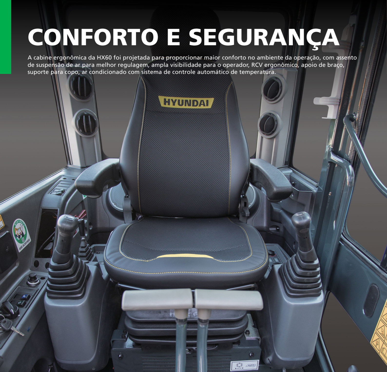
Cabine ROPS com estrutura protetora contra capotamento (ISO3471)
