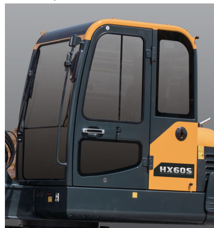
Cabine ROPS com estrutura protetora contra capotamento (ISO3471)
