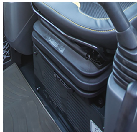
O filtro de ar está localizado abaixo do assento para facilitar a manutenção.
