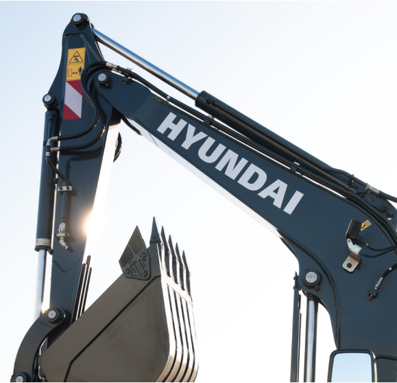
Tubulação de kit rompedor de série
