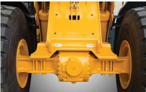
Um eixo aprimorado melhora a dirigibilidade em condições de terreno variável. Os freios autoajustáveis, que regulam automaticamente a folga dos discos, reduzem o tempo de manutenção e melhoram a confiabilidade e o desempenho dos freios.
