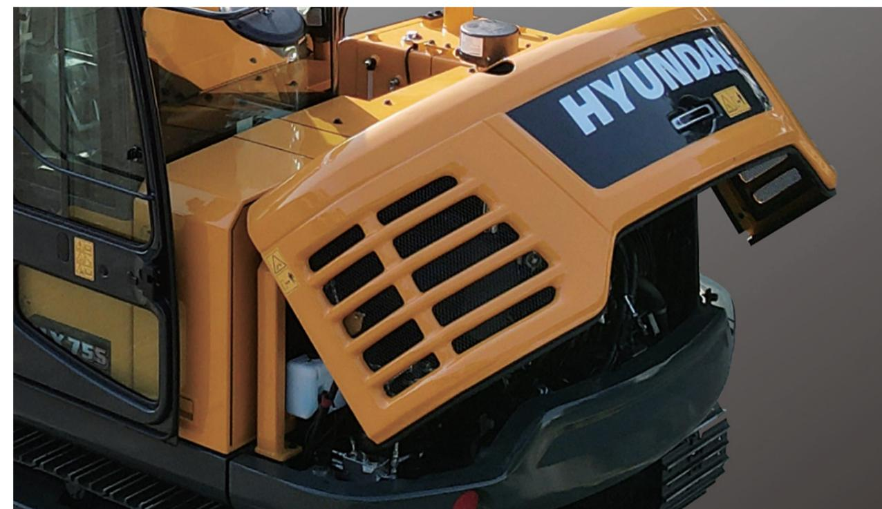
Para melhor dissipação do calor, o diâmetro do radiador e do número de lâminas aumentaram, de 7 para 9.
