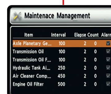
Display de gestão de manutenção
