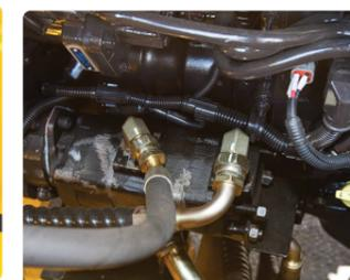
**Conexão do Manômetro de pressão**
