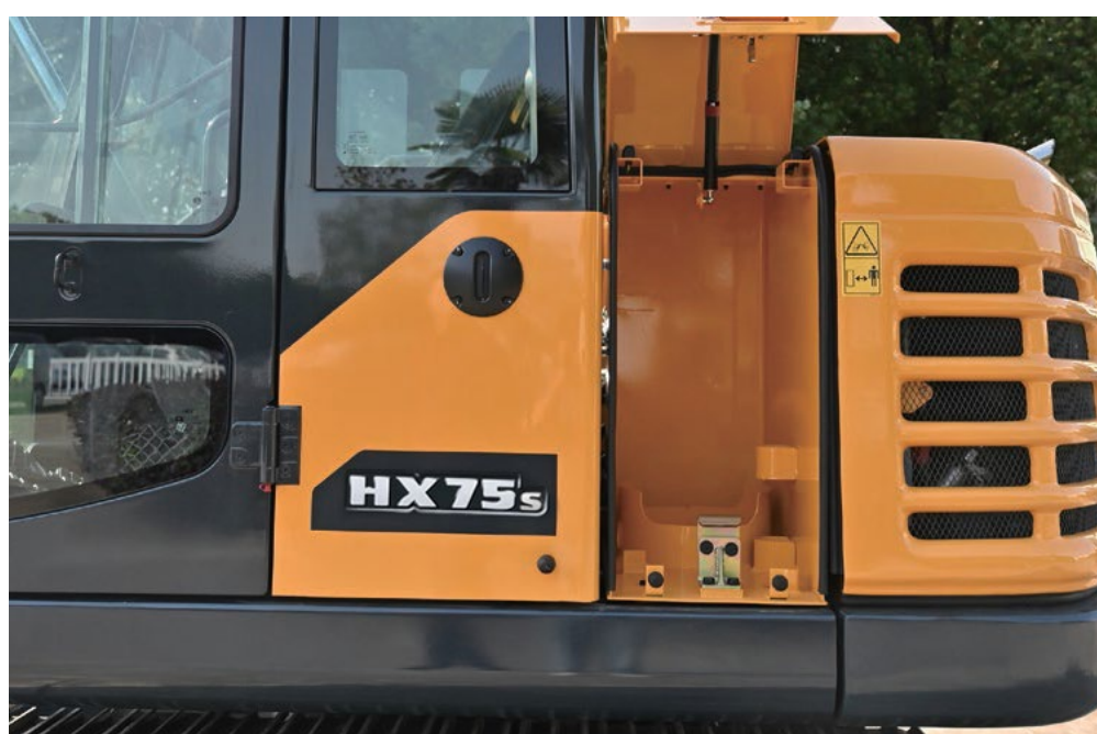
A HX75S possui abertura completa do capô para realizar manutenção de maneira mais rápida e segura.
