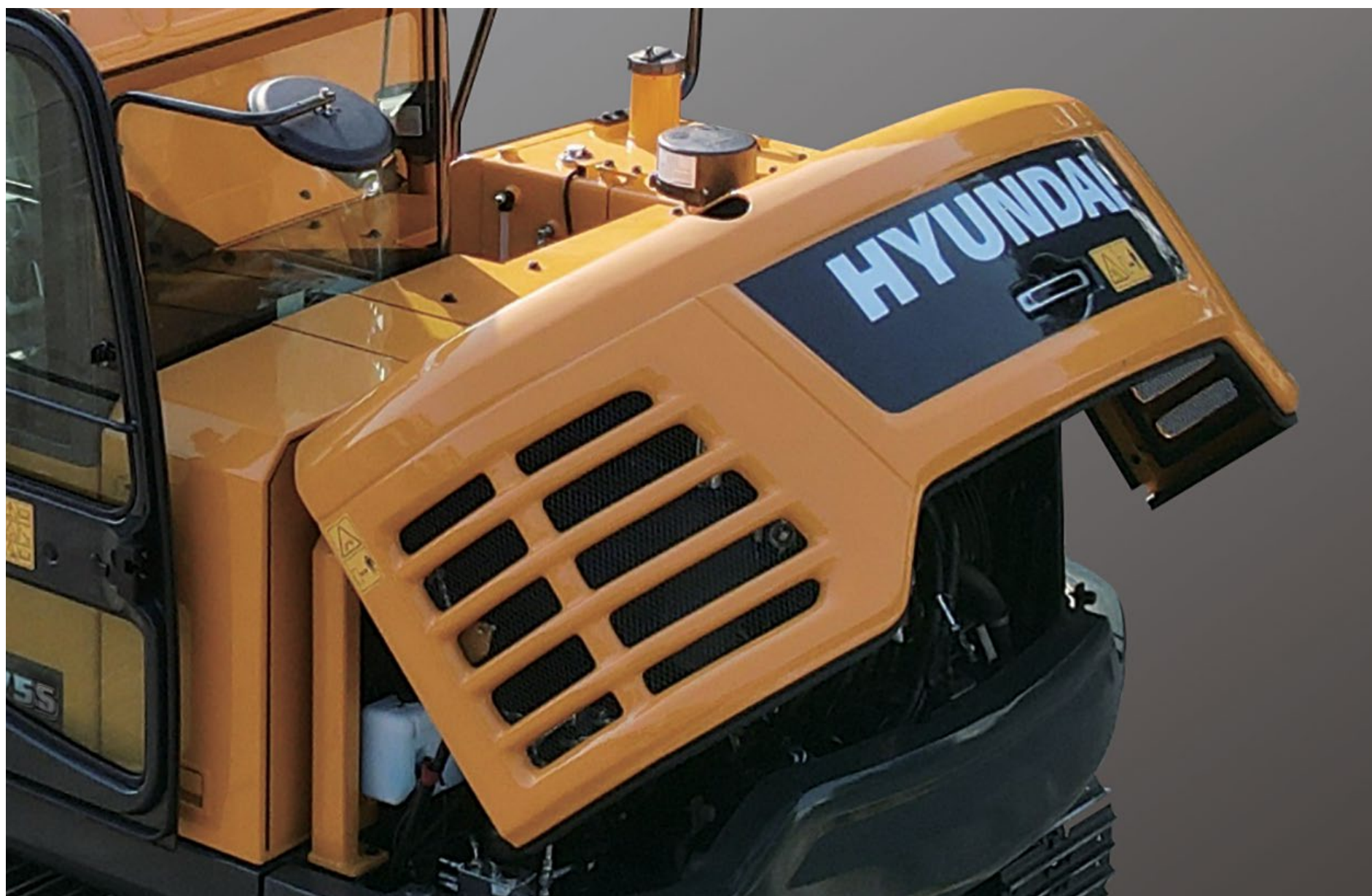
A HX75S possui abertura completa do capô para realizar manutenção de maneira mais rápida e segura.
